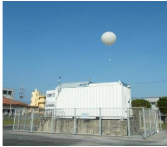
ARSからの自動放球の様子 (気象庁 石垣島地方気象台)
