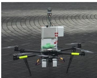
気象センサーと雲粒子ゾンデHYVISを搭載したドローン(上) 雲粒子ゾンデHYVIS本体
