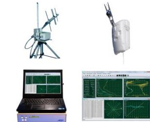
収録に使用したラジオゾンデiMS-100と受信機
