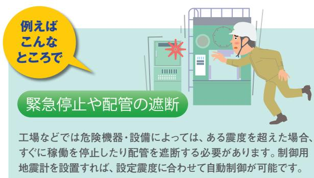
工場などでは危険機器・設備によっては、ある震度を越えた場合、すぐに稼働を停止したり配管を遮断する必要があります。制御用地震計を設置すれば、設定震度に合わせて自動制御が可能です。
