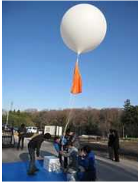
当社、つくば事務所にCO2センサー放球試験 (JST様提供)
