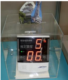
想定南海地震による緊急地震速報を大阪市で受信した場合のQCAST@受信ユニットデモ動作(前回展示時)
