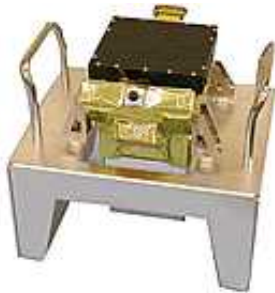
「はやぶさ」に搭載された蛍光X線分光装置
