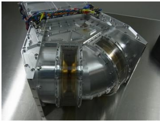
MMS衛星に搭載するFPIイオンセンサ
