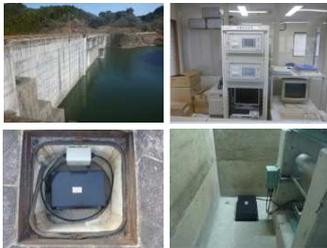
瓜田ダムに設置された計測震度計
