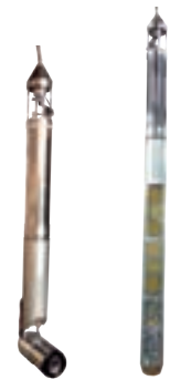
新型LNGタンク内観察装置 撮像装置・照明装置
