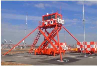
展開された非常用管制塔装置
