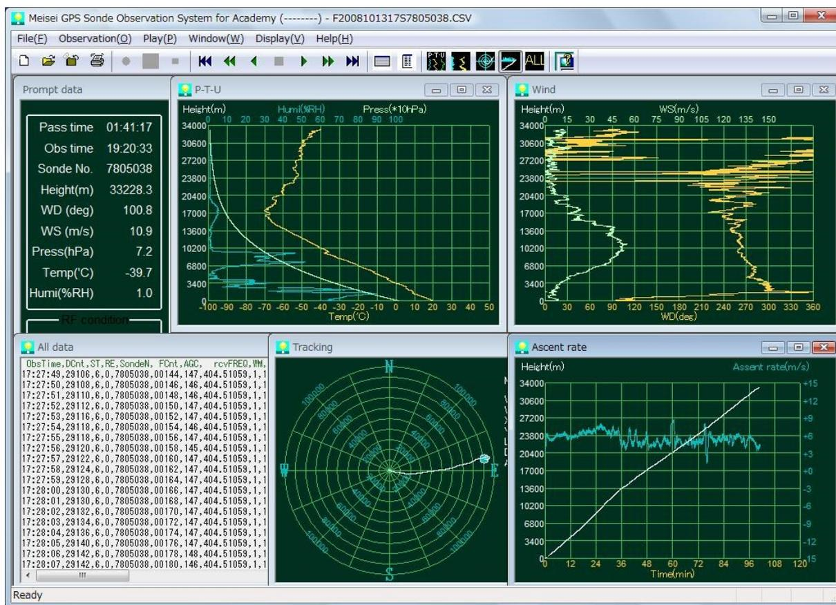
観測ソフトウェア「MGPS\_R」は、ゾンデ飛揚前の点検から、観測終了時のファイル管理までを行います。観測中表示される画面は瞬時データ、PTUデータ<sup>(1)</sup>、風向風速データ、テキストデータ、航跡図及び上昇速度があり、観測状況をリアルタイムで確認することができます。観測データは、飛揚前から、気球破裂後も収録でき、全てCSV形式のファイルで保存されます。また、温度センサやGPSデータに施される補正やフィルタは、設定で外すことも可能で生データからの解析ができます。 <sup>(1)</sup>: 気圧、温度、湿度のこと
