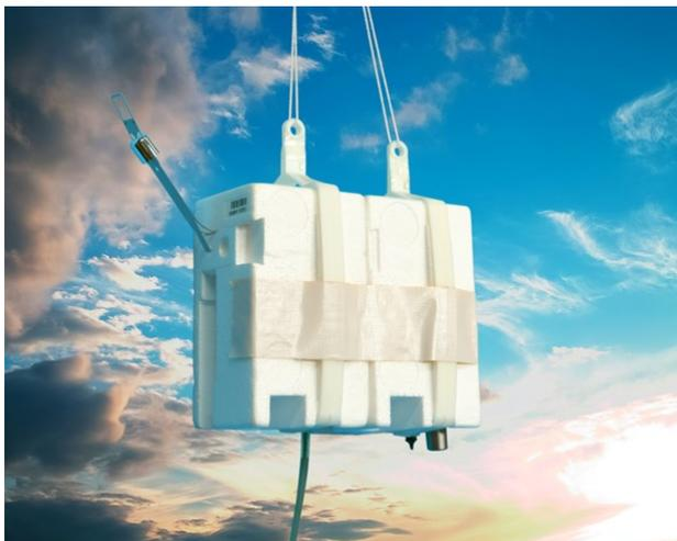
放射能ゾンデ(MNS-13)は、GPSラジオゾンデに放射線センサを接続して使用します。これにより、通常的气温、湿度、高度、風向、風速に加え、 $\beta$ 線と $\gamma$ 線の強度の鉛直分布を測定します。 $\beta$ 線と $\gamma$ 線の強度は1秒毎のパルスカウント値として地上局へ送信されます。
