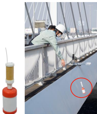
GPS浮子と投下試験の様子
